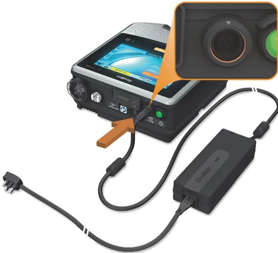
**Hinweis:** Das Netzkabel ist mit einem arretierenden Stecker zum Drücken und Ziehen ausgestattet. Um das Netzkabel abzunehmen, fassen Sie es am Gehäuse und ziehen Sie den Stecker vorsichtig aus dem Gerät. Sie sollten weder das Außengehäuse verdrehen noch am Kabel ziehen.
