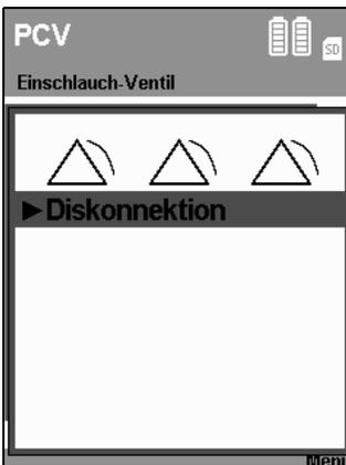
Wird durch einen Fehler ein Alarm ausgelöst (hier: Diskonnektionsalarm), können Sie durch Drücken der Alarm-Quittierungstaste
