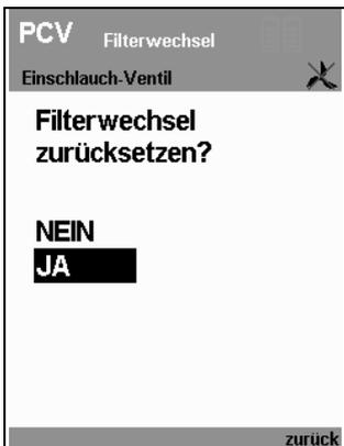
2. Die Abfrage **Filterwechsel zurücksetzen?** erscheint. Wählen Sie mit dem Drehknopf **JA** und bestätigen Sie die Auswahl durch Drücken auf den Drehknopf.
