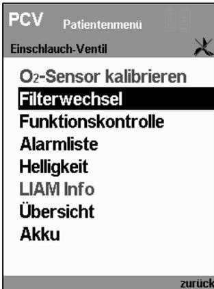
1. Um die Filterwechselanzeige zurückzusetzen, drücken Sie die Menütaste
